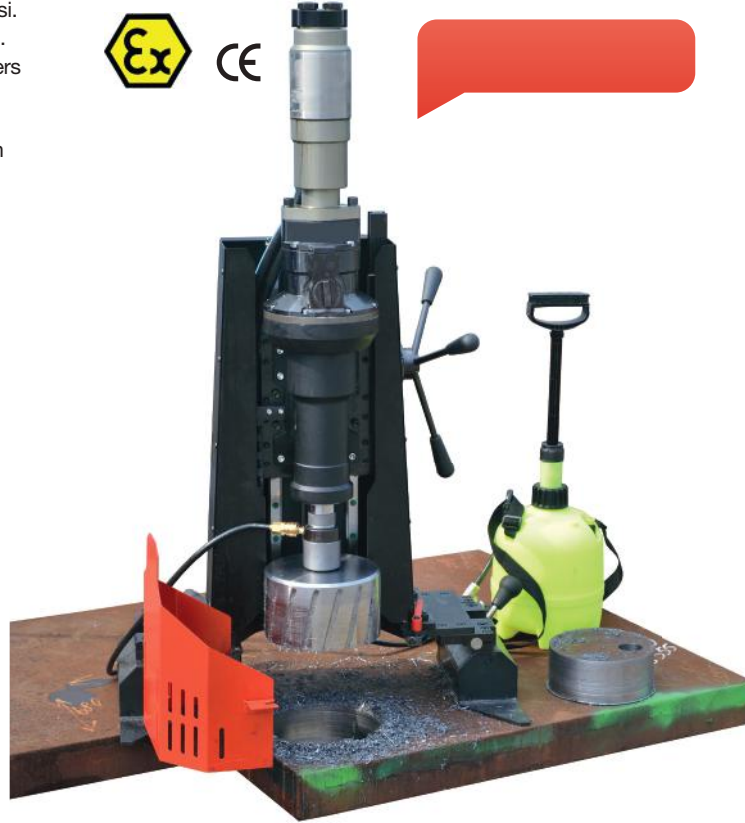
Ø 200 mm kesici delme kapasiteli
