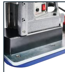
Manyetik olmayan bir yüzeyde delme işlemi yaparsınız
