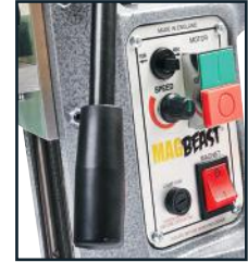
Farklı düzeylerde hız & ileri/geri basit control paneli
