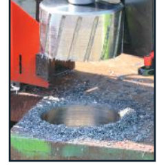
Ø 200 mm kesici delme kapasiteli
