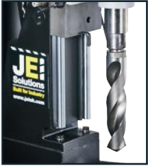
5MT 52 mm'e kadar matkap kullanılır
