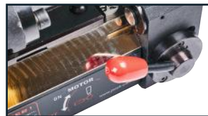
Motor ve manyetik için Farklı açma kapama düğmeleri hatlı çalıştırmayı önlemek için.
