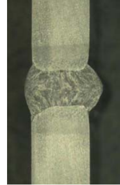
Sac kalınlığı 5 mm Hava boşluğu 3 mm
