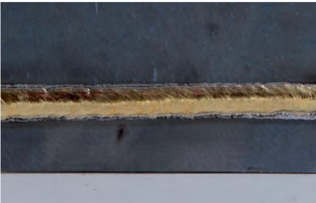
Usibor® gibi yüksek dayanımlı sacların lehimlenmesi
