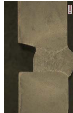
Sac kalınlığı 10 mm, tek taraflı faz 15 derece, 4 mm hava boşluğu
