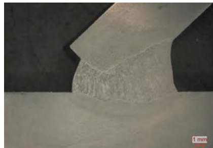
10 mm çıkıntılı sac kalınlığı, 35° kaynak ağızı açısı
